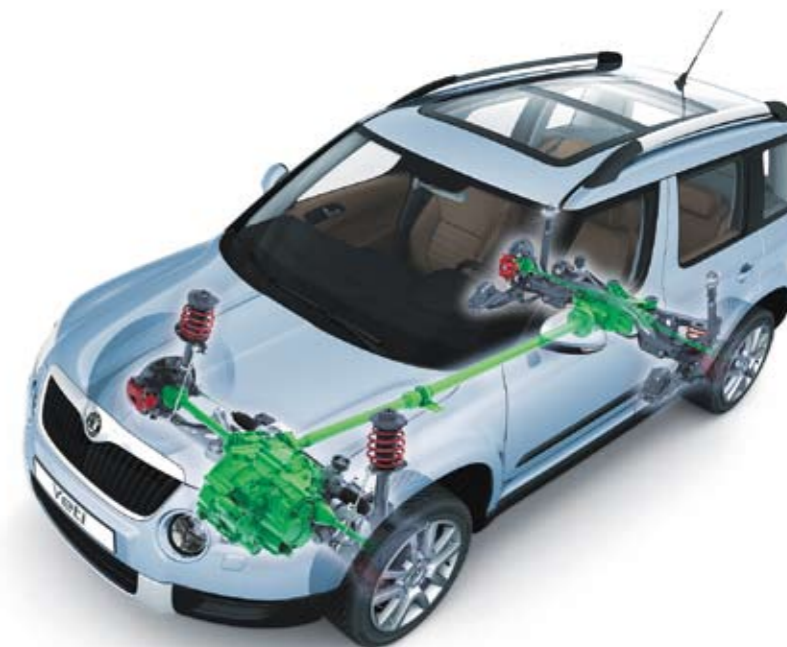
Škoda Yeti с полным приводом и сцеплением 4-го поколения Haldex (двигатели 1.8 TSI/112кВт)
