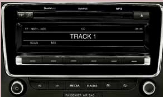
Raadio SWING*, 2 DIN on varustatud AM/FM-raadio, RDS- ja TP-süsteemidega, dipoolantenniga FM-vastuvõtuks, CD-mängijaga, CD-vaheti ühendusega, CD-MP3- ja CD-WMA-pleieritega, võimendiga (4 x 20 W) ja ekvalaiseriga digitaalse signaalprotsessoriga. Ekraan näitab kliimaseadme CLIMATRONIC seadistusi, parkimisandureid ja kellaega ning välis temperatuuri. Olemas on ka hands-free-seadme ühendamisvõimalus ning Line-In-liides. Ühilduvus multifunktsioonilise roolirattaga on tagatud, mugav elektrooniline lukustus.
