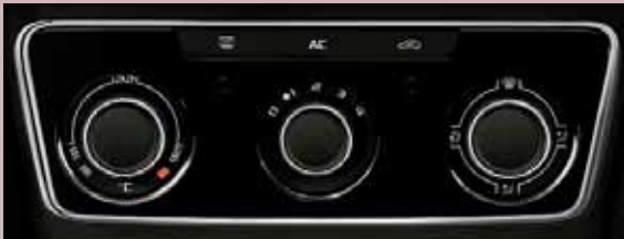
Kliimaseade CLIMATIC hoiab auto sõitjateruumis Teie poolt valitud temperatuuri. Ohuvoolu intensiivsust ja suunda saab käsitsi reguleerida.
