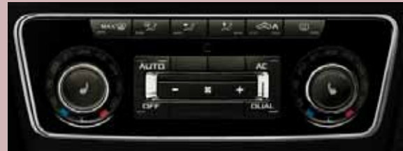
Elektroonilise regulaatoriga kahe tsooniga kliimaseade CLIMATRONIC pakub maksimaalset reisikomforti. Soovitud temperatuuri saab individuaalselt seada auto paremale ja vasakule poolele ja seda hoitakse automaatselt. Ka ohuvoolu intensiivsust ja suunda reguleeritakse automaatselt.
