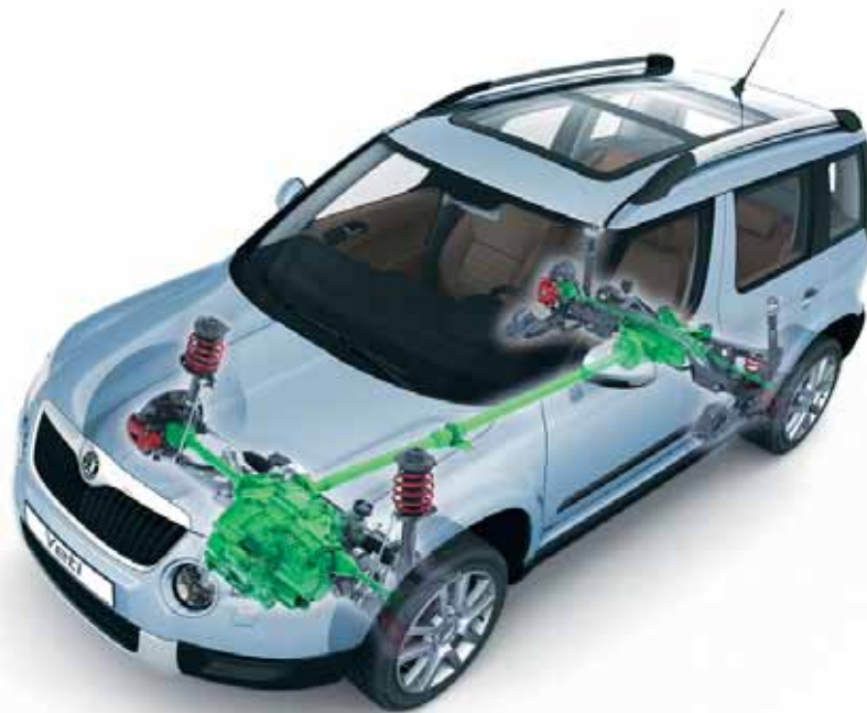
Nelikveoga Škoda Yeti neljanda põlvkonna Haldex-siduriga (mootorid 1.8 TSI/118 kW ja 2.0 TDI CR DPF/81 kW; 103 kW ja 125 kW)
