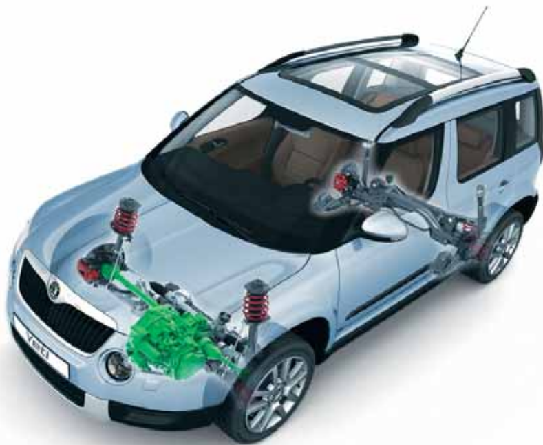
Esiveoga Škoda Yeti (mootorid 1.2 TSI/77 kW ja 2.0 TDI CR DPF/81 kW)
