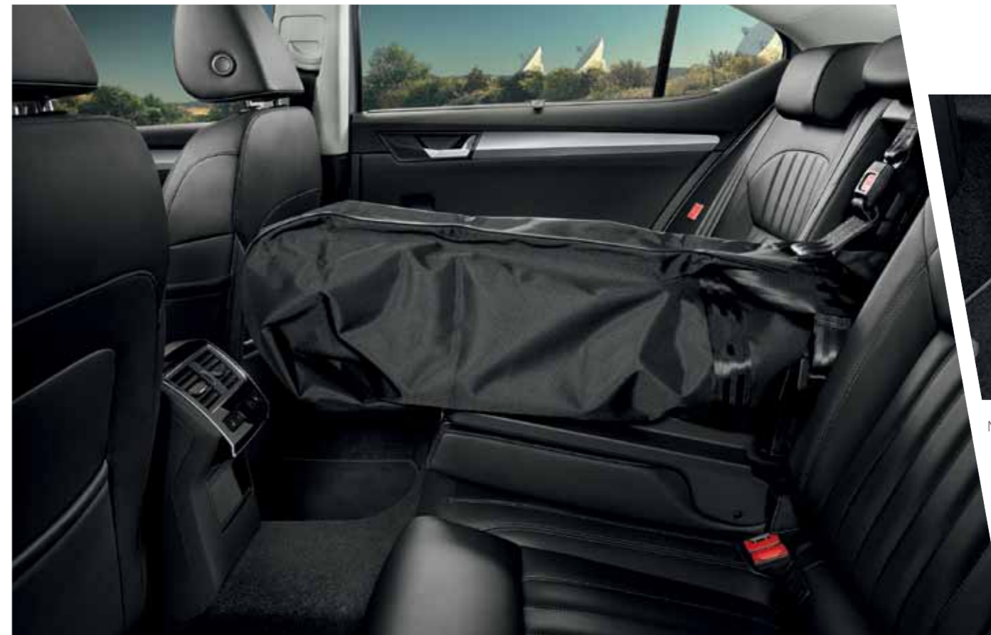
Eemaldatavat Unibagi kotti, mis on mõeldud suuskade või lumelaua transpordiks, saab hoida pakiruumi ja salongi vahelises avas.
