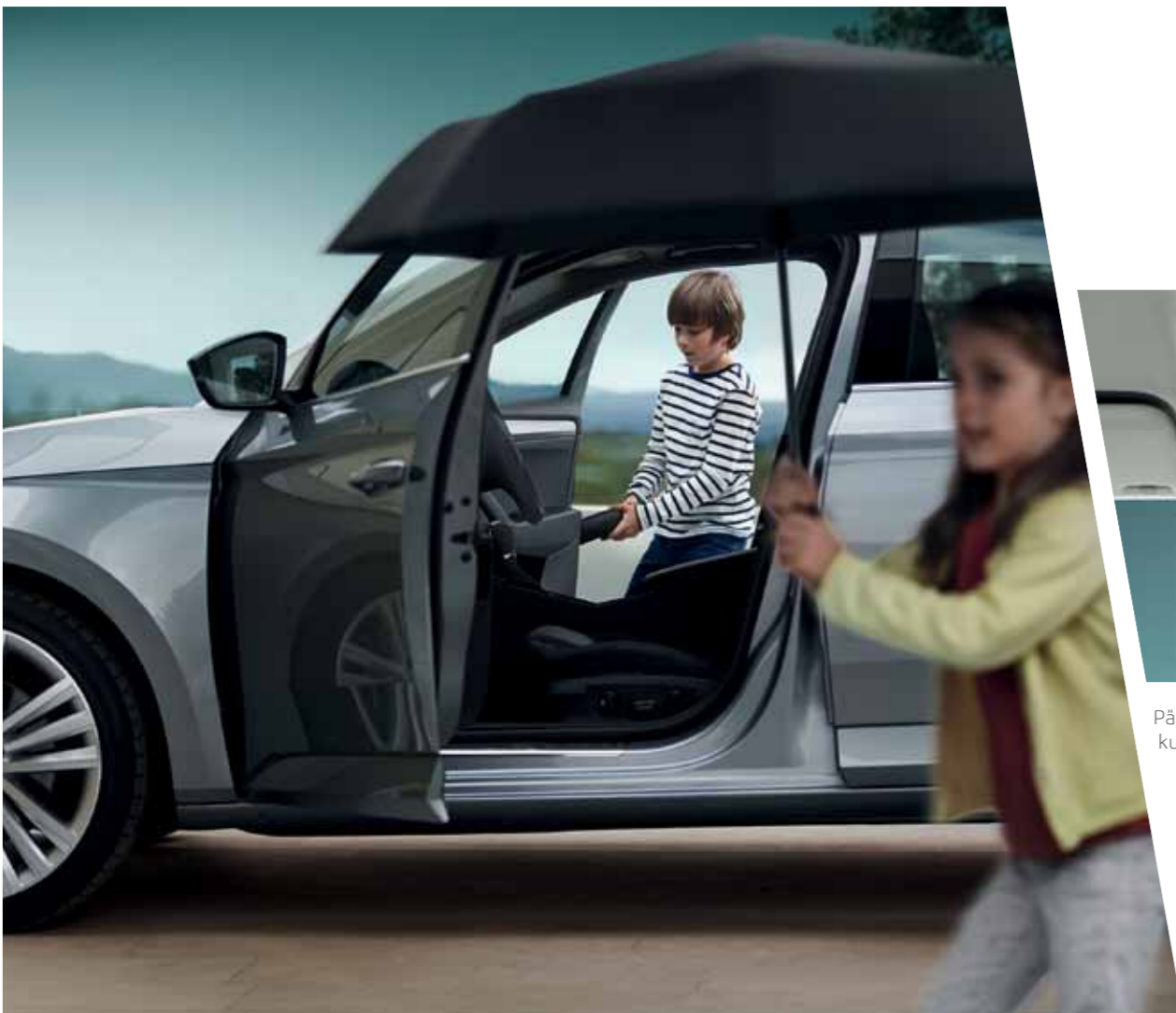
Mõlemas esiukses on geniaalne laegas, mis sisaldab Superbi originaalvihmavarju. Kui märg vihmavari oma kohale tagasi asetada, voolab nõrguv vesi autost välja ja salong jääb kuivaks.
