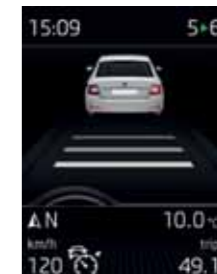
Front Assisstant lähimõõruse jälgimissüsteem
